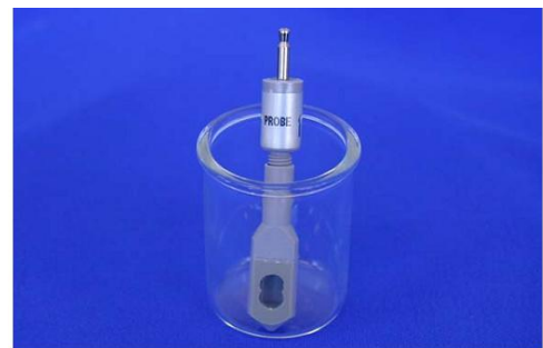
图11 在脱水状态下储存的味觉传感器
