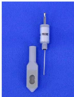
图5 拔出传感器的针插型电极端
