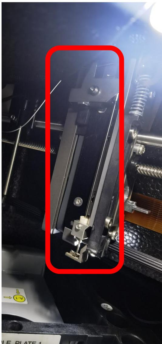
✓进样针安装到位，每次实验前放样品时请留意观察进样针的状态。
